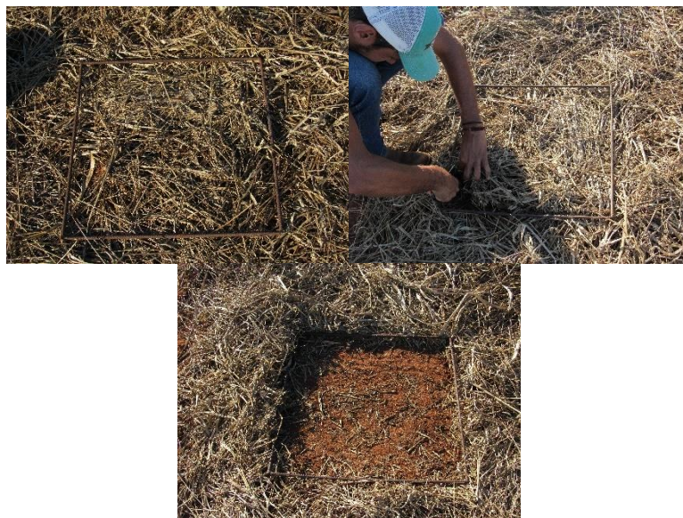
Figura 3. Esquema mostrando a sequência das operações realizadas para a coleta das amostras de palhada do braquiária com o auxílio de um quadro de 0,5 \times 0,5 m ( 0,25 m 2 ). UEMS. Cassilândia (MS), 2017. Fonte: Os autores.
