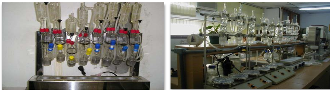
Figura 10. (Imagem esquerda): aparelho para extração de gordura tipo Goldfish, unidades com seis extratores, equipado com suporte para cartucho de vidro. (Imagem direita): tubos coletores de éter ou Soxhlet. Fonte: https://ceunes.ufes.br .
