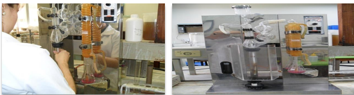
Figura 9. A. Titulação para a determinação da dosagem de nitrogênio. B. Viragem na titulação para a determinação da dosagem de nitrogênio total. Fonte: Arquivo pessoal dos organizadores
