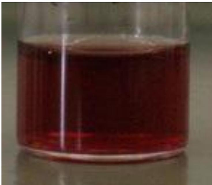
**Figura 1.** Imagem da dispersão coloidal de nanopartículas de ouro (NPs de Au). Fonte: Os autores.
