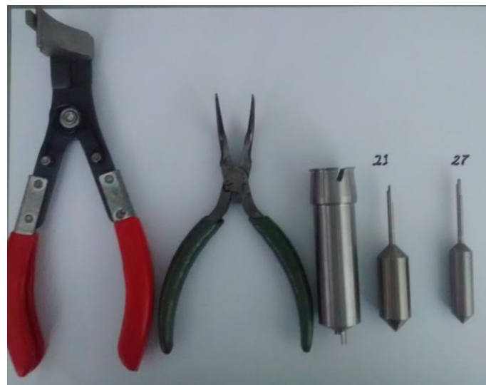
Figura 3.7. Acessórios utilizados no para determinação da viscosidade Rotacional – Viscosímetro Brookfield do LEP/UFCG.
