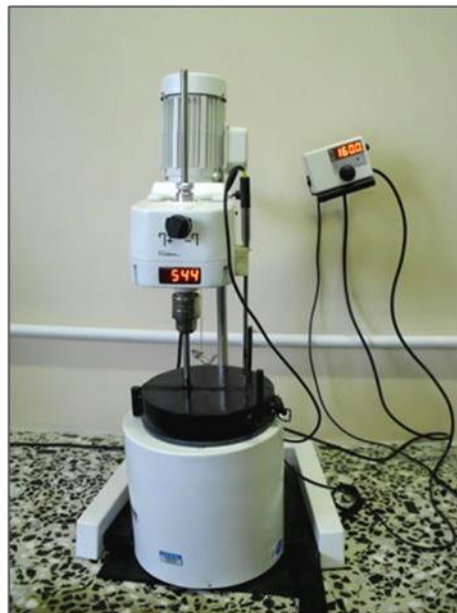
Figura 3.1. Misturador de Cimentos Asfálticos Modelo 722D – LEP/UFCG utilizado para preparo das misturas de aditivos com o CAP.
