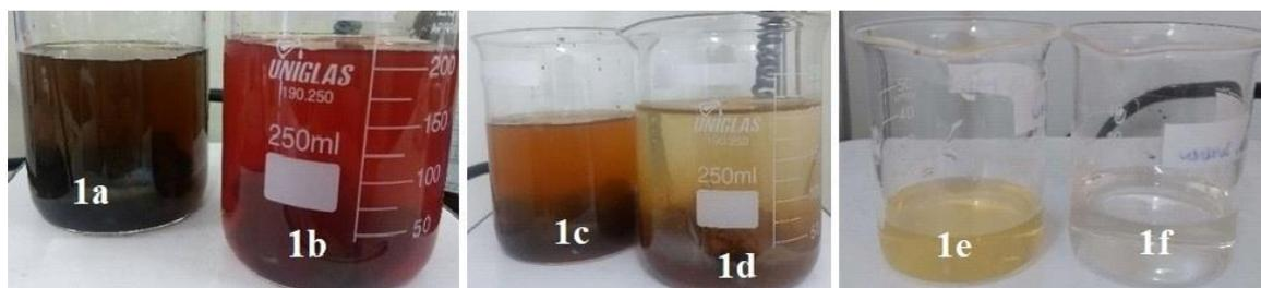
**Figura 3.** Remoção da coloração da solução do corante vermelho ponceau 4R com o Processo Foto-Fenton ( $\text{Fe}/\text{H}_2\text{O}_2/\text{UV}$ ): (1a) 0 min; (1b) 30 min; (1c) 90 min (1d) 120 min; (1e) 180 min (1f) 210 min. Fonte: os autores.
