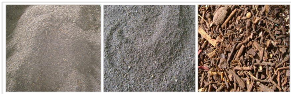
Figura 2.07. Compostos tipo pó e farelo e o rejeito originado da co-compostagem de lodos de tanques sépticos coletivos e resíduos sólidos orgânicos domiciliares. Campina Grande-PB. Fonte: autora.
