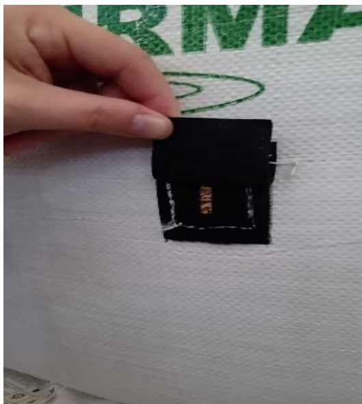
Figura 4. Embalagens big-bag com a válvula de velcro. Fonte: Vitória Zanetti Zanandrea.
