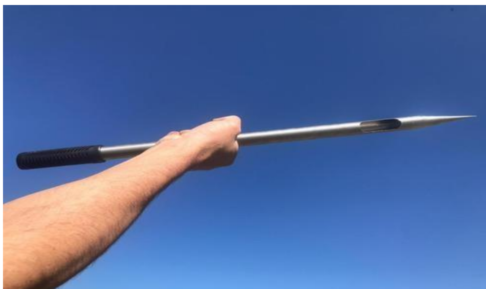
Figura 2. Modelo de calador tipo simples. Fonte: Mercado Livre.
