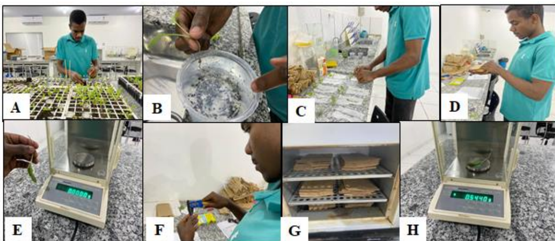
Figura 3. (A) Coleta das plântulas nas bandejas. (B) Lavagem das raízes para retirada do substrato. (C) Medição de altura de plântulas e comprimento de raízes. (D) Divisão de parte aérea e raízes para pesagem. (E) Pesagem para massa fresca. (F) Aferição do diâmetro do coleto. (G) Secagem em estufa com circulação de ar forçada para obtenção de massa seca. (H) Pesagem massa seca. Fonte: Os autores.
