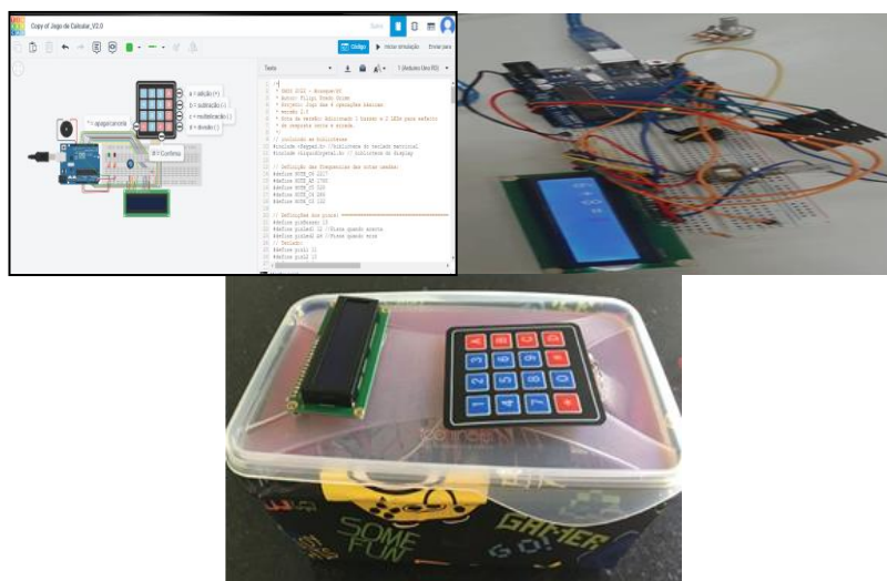
Figura 2. Programação do jogo matemático na plataforma virtual Tinkercad (a esquerda superior), execução das quatro operações básicas da matemática (a direita superior) e caixa caseira (centro inferior). Fonte: Relatório UnirG/CNPq/Outubro de 2022.
