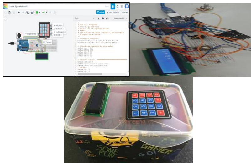
Figura 2. Programação do jogo matemático na plataforma virtual Tinkercad (a esquerda superior), execução das quatro operações básicas da matemática (a direita superior) e caixa caseira (centro inferior). Fonte: Relatório UnirG/CNPq/Outubro de 2022.
