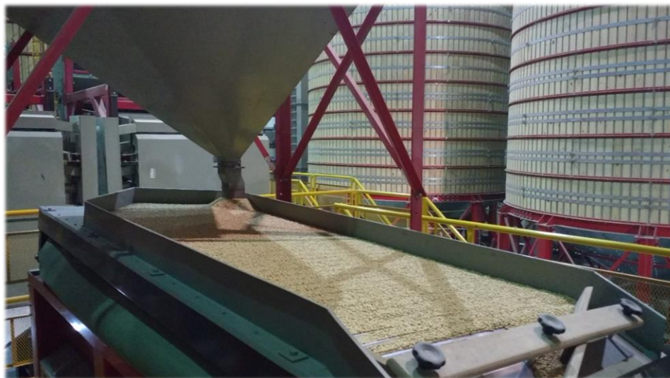
Figura 6. Mesa de gravidade, mostrando o reservatório de sementes que alimenta a mesa. Dom Pedrito, RS, 2021.
