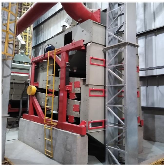
Figura 1. Máquina de ar e peneiras. Dom Pedrito, RS, 2021.
