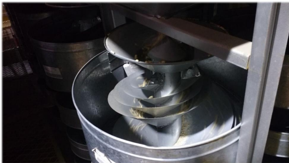
Figura 4. Detalhe do separador em espiral. Dom Pedrito, RS, 2021.
