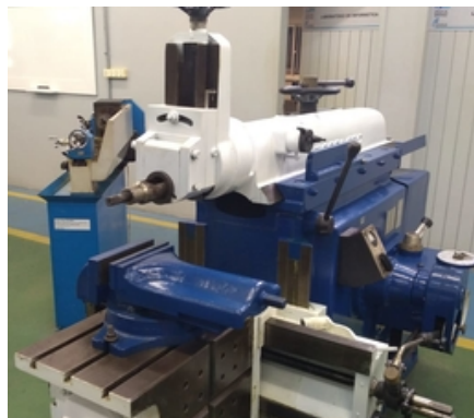
Figura 1.5. Mecanismos de retorno rápido e Plaina limadora. Fonte: https://labman.ct.ufrn.br/
