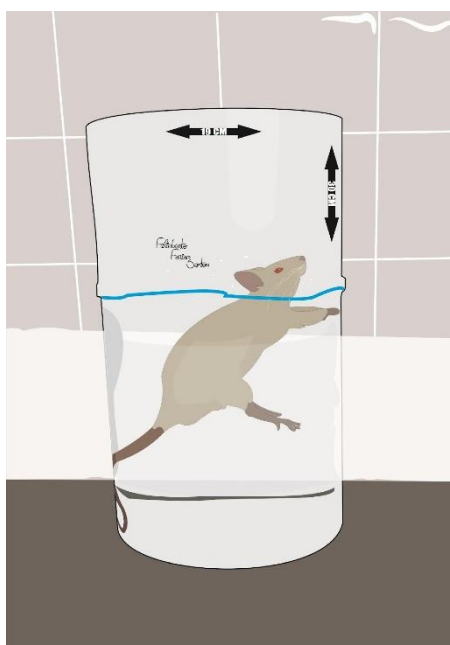
Figura 2. Aparelho para teste de Nado Forçado. Fonte: desenho de Felisberto Farias Santos (Santos, 2015). Fonte: Arquivo pessoal.
