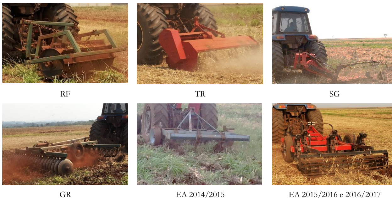
Figura 1. Equipamentos de manejo da palhada e solo. Rolo-Faca (RF); Triturator (TR); Segadora (SG); gradagem (GR); Escarificador (EA). Fonte: os autores.
