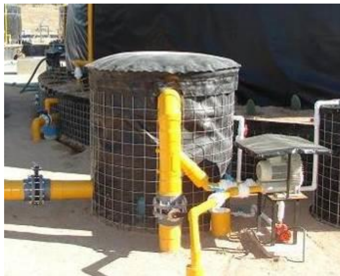
Figura 9. Filtro de agua y piedra tezontle para biogás de biomasa de nopal.
