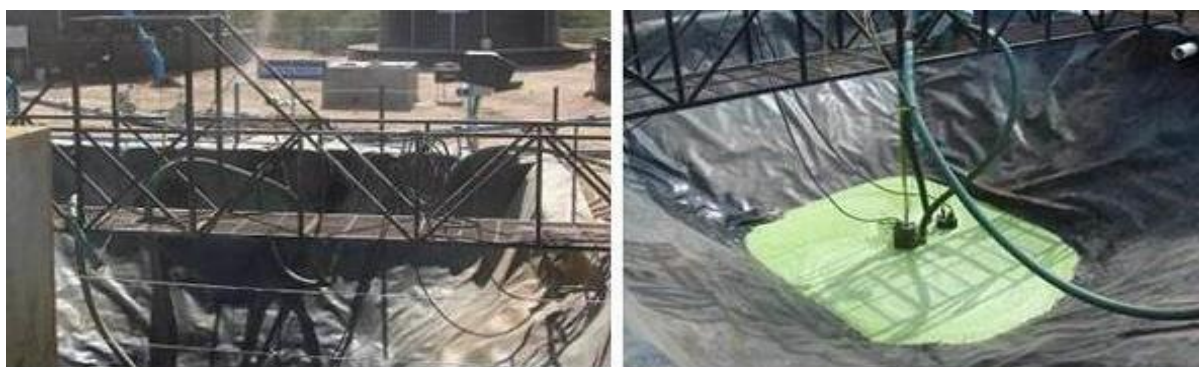
Figura 5. Homogeneizador de biomasa de nopal triturada y estiércol lavado.
